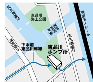
4月から東京都下水道局の東品川ポンプ所（東品川3-9）が稼動しています。ここでは、目黒川左岸低地部（五反田地区など）の雨水をくみ上げ京浜運河に放流し、浸水を防ぎます。また、汚れが多い降り初めの雨水をためて、芝浦水再生センターへ送水します。
