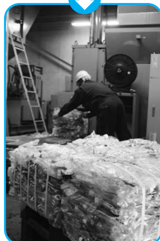
ペットボトル圧縮梱包機でプレス。1個は約22kg
