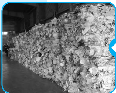
製紙工場へ運ばれるのを待つ。1ブロックは約1.2t、新聞の量にして約9年分にもなる
