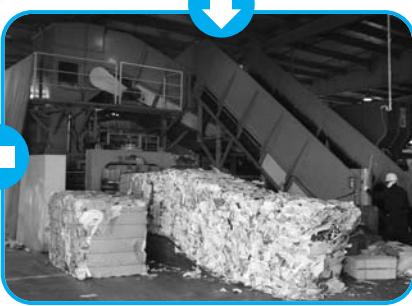
古紙類圧縮梱包機にかけられ、一定量ずつプレスされ排出される
