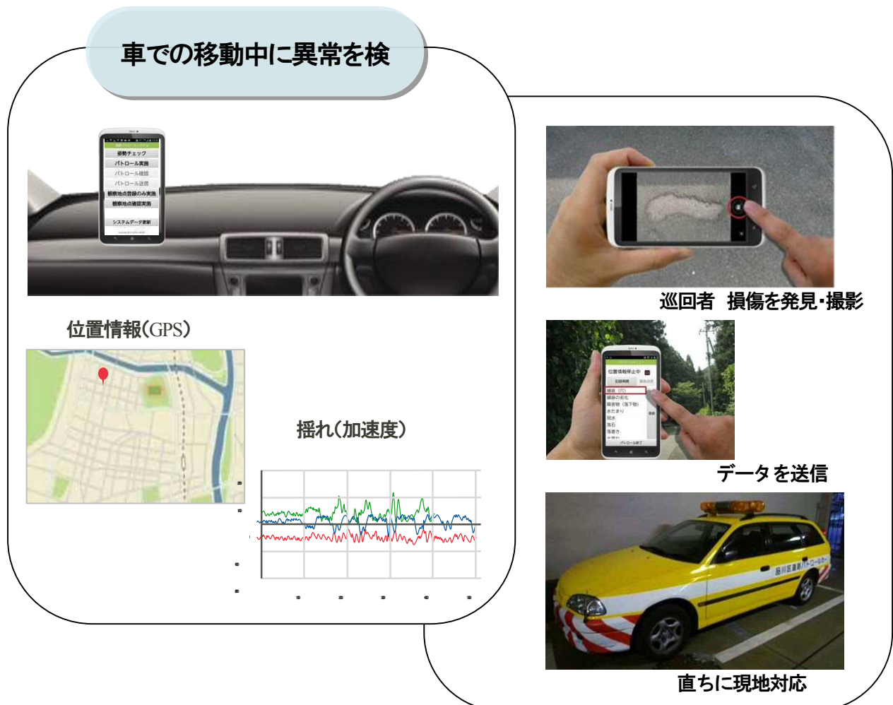
【道路段差検知システムのイメージ】
