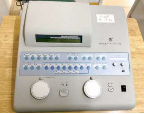
▲難聴通級指導学級で使用しているオーディオメーター（聴力検査機器）
