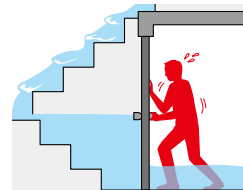
水圧でドアが開かない
