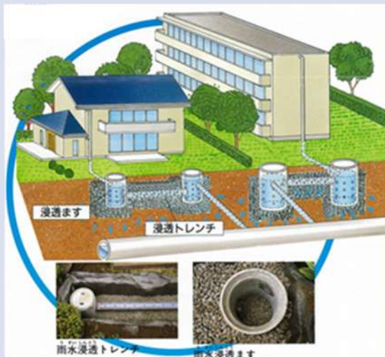
図 14 雨水浸透施設設置イメージ
