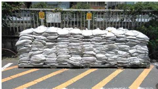
図 21 水防用土のう置き場(目黒川沿い)
