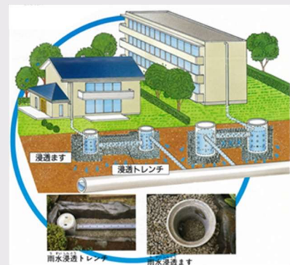
図4-6 雨水浸透施設設置イメージ
