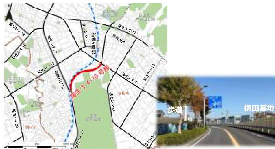
福生3・4・10号線 計画幅員18m 現道幅員約12.5m
