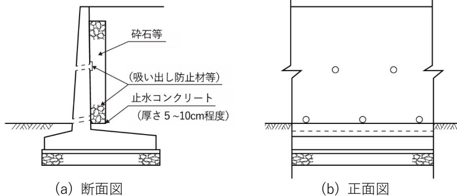
図 3-26 鉄筋コンクリート擁壁の断面図および水抜穴設置図
