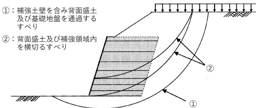
図3-47 想定される全てのすべり面に対する安定の照査 [引用]道路土工-擁壁工指針（（社）日本道路協会、平成24年7月）、一部加工
