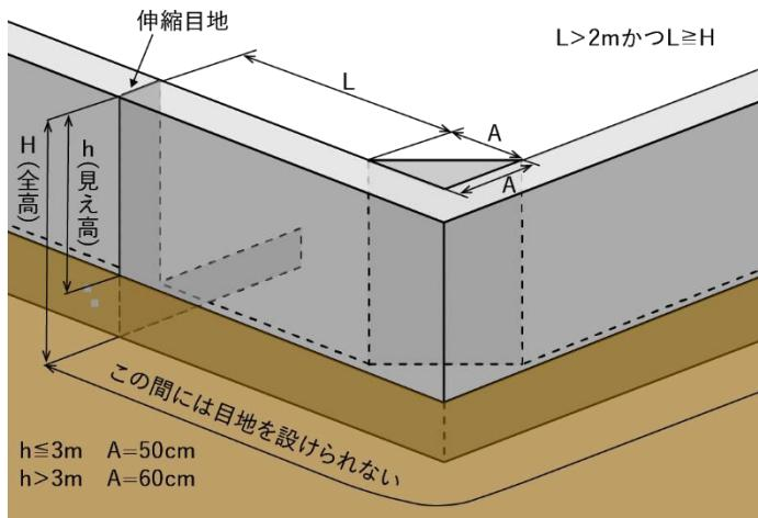
図 3-23 鉄筋コンクリート造擁壁等の伸縮目地および隅角部の補強位置①
