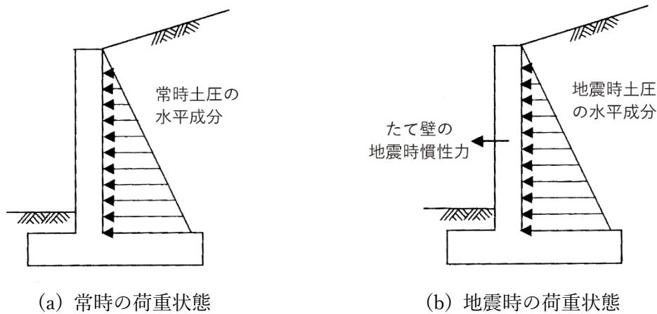
図 3-40 壁の断面計算における荷重状態
