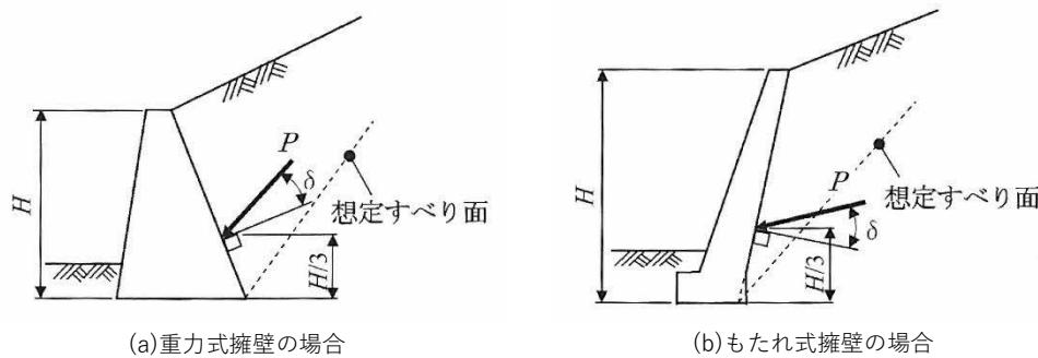
図 3-30 土圧作用面（重力式擁壁等）
