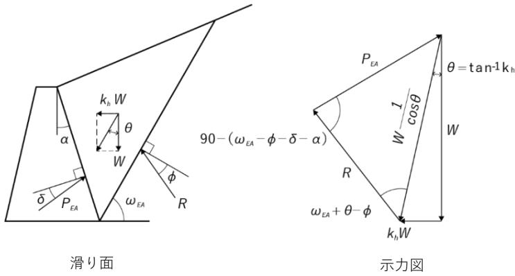
図 3-34 地震時主働土圧の考え方
