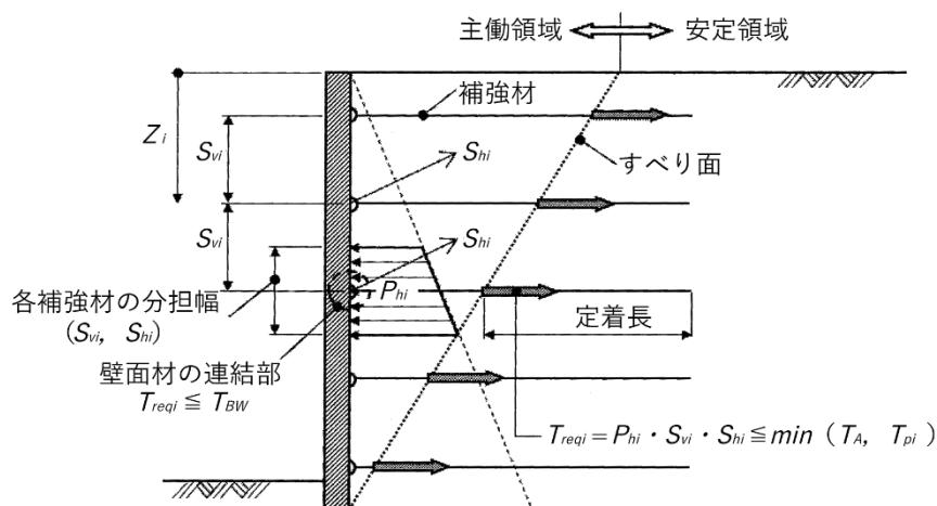
図 3-53 補強材に作用する引張力の考え方
