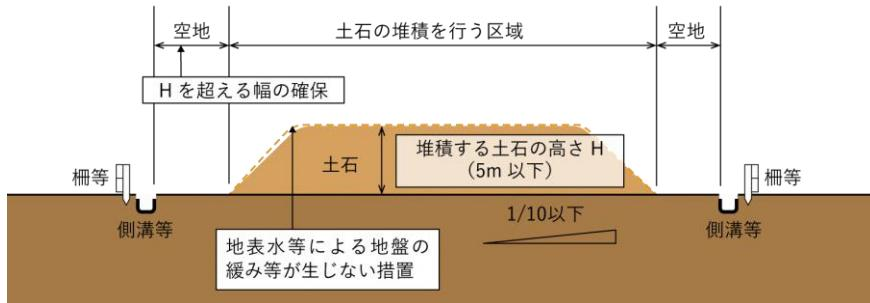
図 3-75 堆積する土地の基準（高さ 5m 以下）
