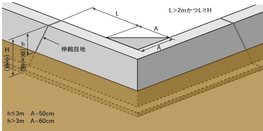
図 3-25 練積み造擁壁の伸縮目地および隅角部の補強位置
