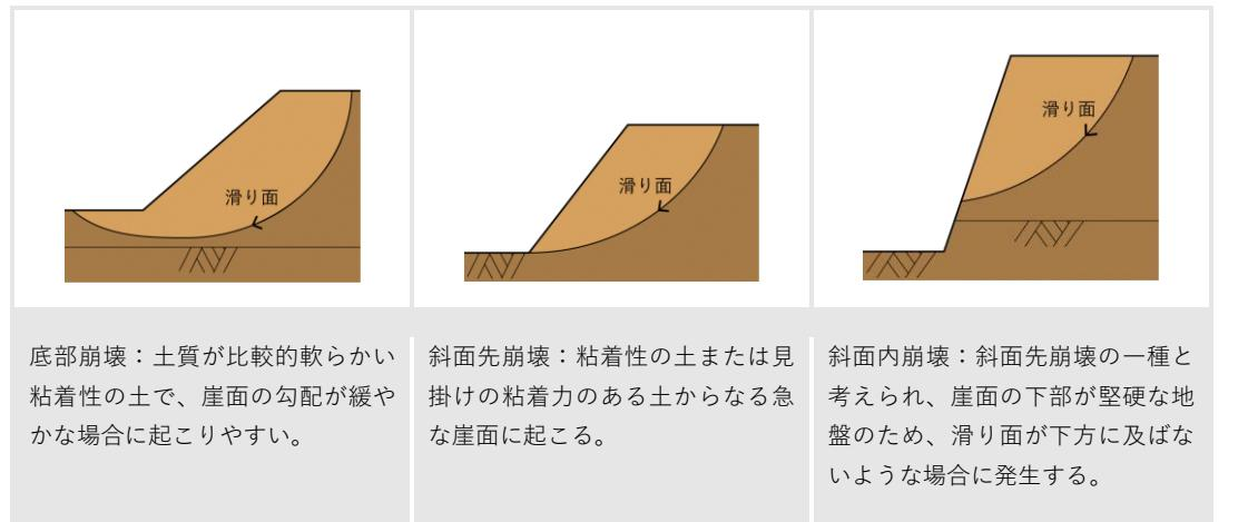
図 3-8 斜面崩壊の種類
