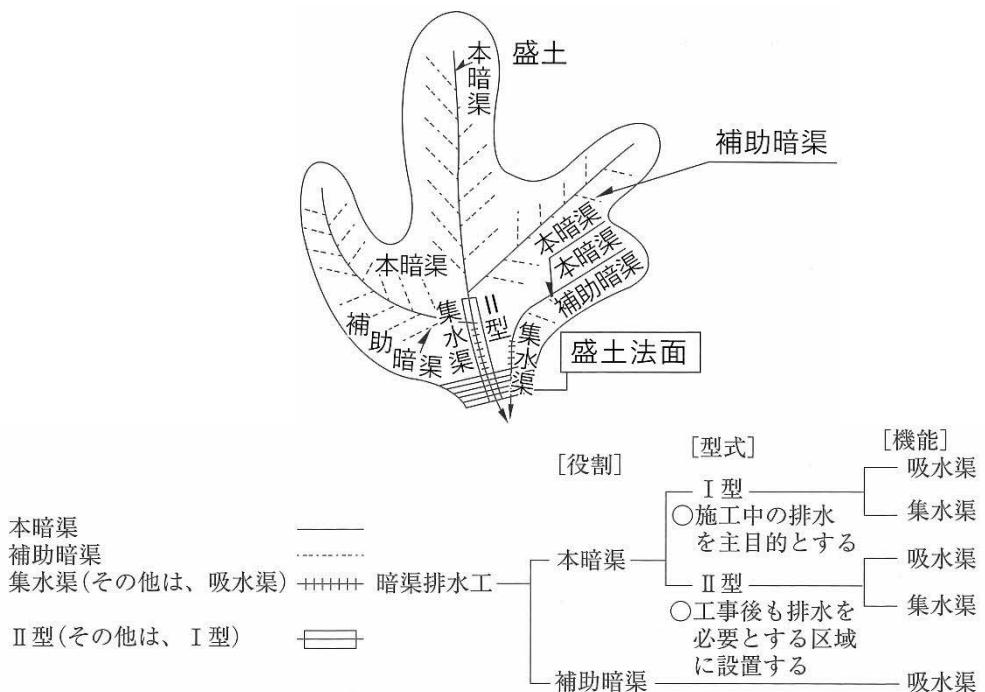
図 3-69 地下水排水工の配置
