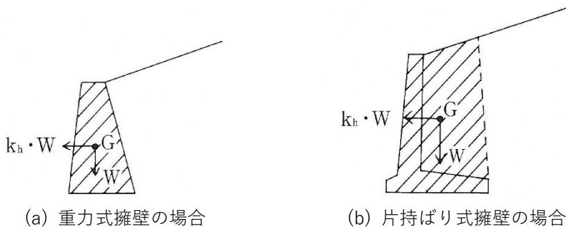
図 3-36 地震時慣性力の考え方
