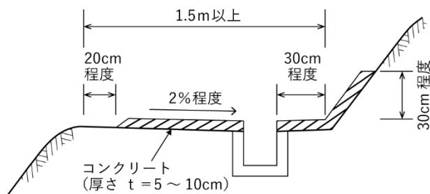
図 3-65 小段排水工[引用]道路土工 盛土工指針
