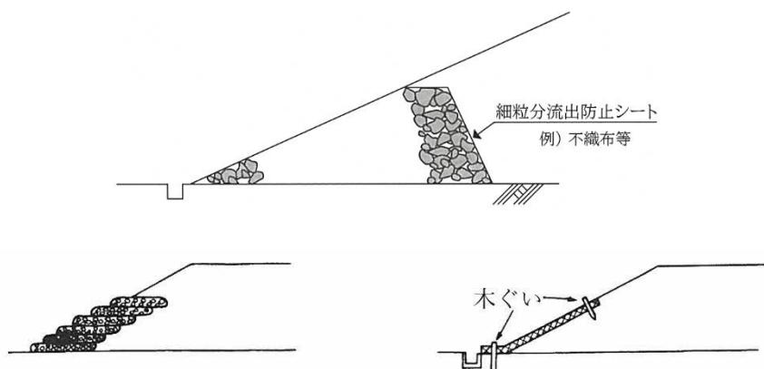
図 3-71 法尻工の例 [引用]道路土工 盛土工指針
