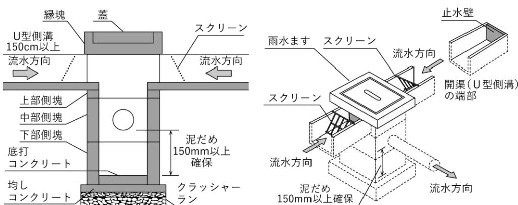
図 3-61 排水工の標準構造図
