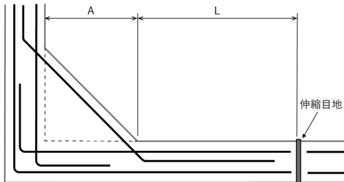
図 3-24 鉄筋コンクリート造擁壁等の伸縮目地および隅角部の補強位置②
