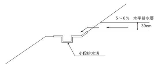
図 3-72 水平排水層端部
