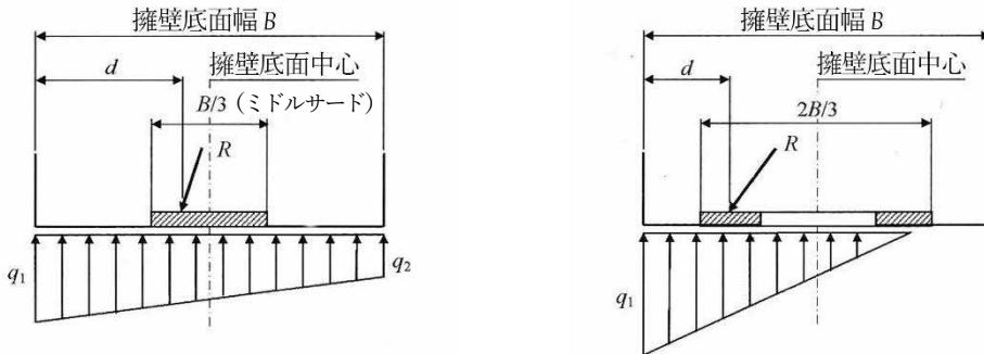
図 3-38 地盤反力度の求め方 [引用] 道路土工擁壁工指針 ((社)日本道路協会、平成24年7月)、一部加工
