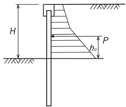
図 3-82 鋼矢板擁壁に作用する土圧および水圧
