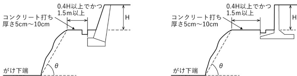
図 3-15 斜面の擁壁の構造
