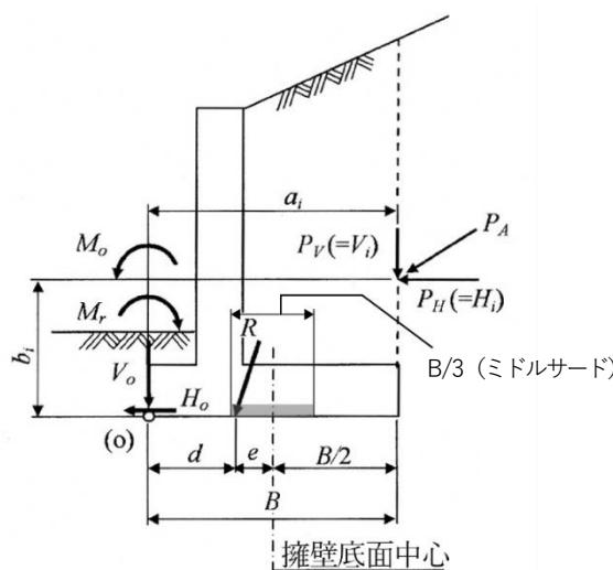
図 3-37 合力作用位置の求め方 [引用]道路土工擁壁工指針 ((社)日本道路協会、平成24年7月)、一部加工
