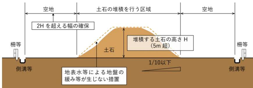
図 3-76 堆積する土地の基準（高さ 5m 超）
