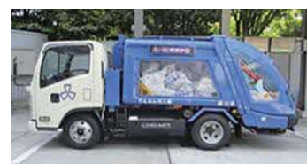
* スケルトン車両： 清掃車を改造して仕組みが分かるようにした車両
