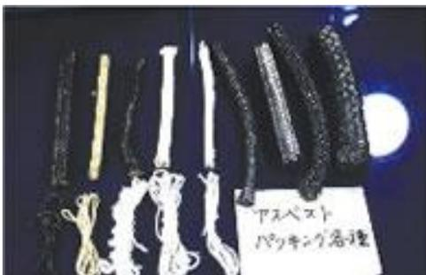
タンクなどを接続する際の継目からの液漏れを防止する為のシール材としてパッキングやガスケットなどに使用されています。
