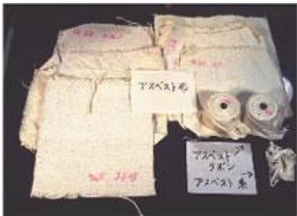
保温材や耐火被覆板のうち、板状のものは外壁や配管に固定され、ひも状のものは曲管部に巻き付けて使用されていました。
