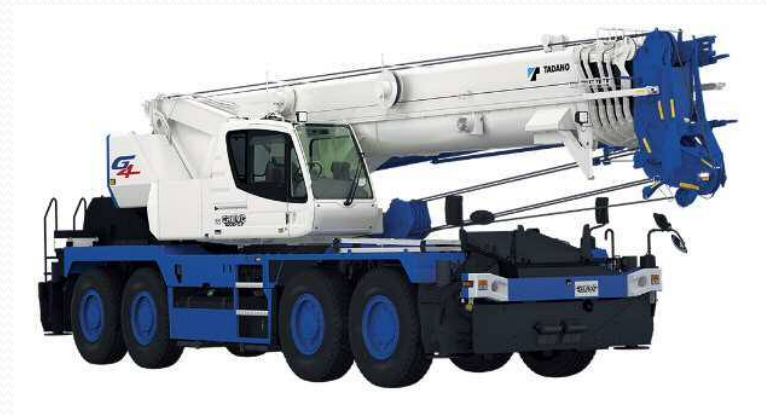
70 t クレーン
