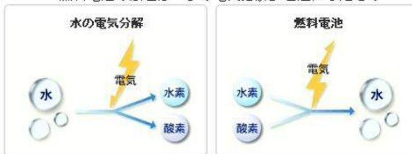
「水の電気分解」と「燃料電池」のしくみの違い
