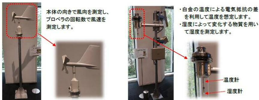
本体の向きで風向を測定し、プロペラの回転数で風速を測定します。
