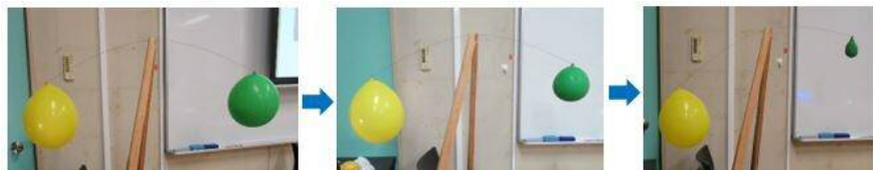
①黄色風船と緑色風船のバランスが取れている。その後、緑色風船に画鋸で小さな穴をあけた。(風船が割れないようにしてある)→②→③緑色風船の空気が抜けてバランスがくずれた・・・空気にも重さがあることが分かった。
