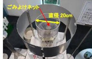
雨や雪が降ると、水が転倒マスにたまり、0.5mmごとに転倒マスが1回傾きます。
