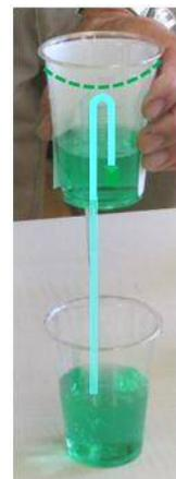
【理由】ストローの中に水が入っていると大気圧が水面を押し出すことによって、ストローの中の水全体が移動します。
