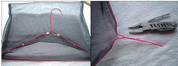
◆突っ張り棒の細い方のキャップをはずし、伸ばしたハンガーのねじ込みます。引っ張り棒の中にはネジが切つてあるので、ねじ込むことにより、強度が増します。
