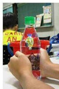
浮沈子を水がいっぱい入った炭酸飲料用の500mlペットボトルの中に入れ、ペットボトルのフタをしっかりとしめます。ボトルを押すと浮沈子は沈み、力をゆるめると浮きます。
