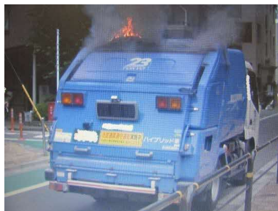
内部で火災発生した収集車
