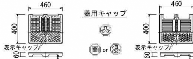
落葉対策型蓋 (バリアフリー対応) 詳細図
