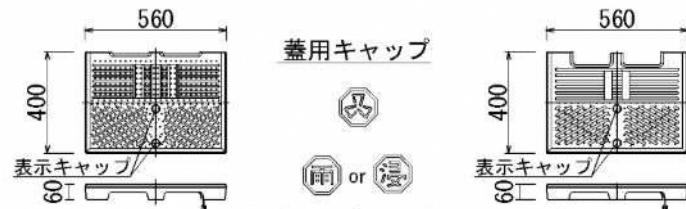
落葉対策型蓋 (バリアフリー対応) 詳細図
