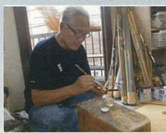
竿にする竹を切って組み上げる作業の後、つなぎ部分を絹糸で縛り、漆を塗ります。材料の竹は九州産の布袋竹を使い、穂先にはクジラのひげが最適とか。
