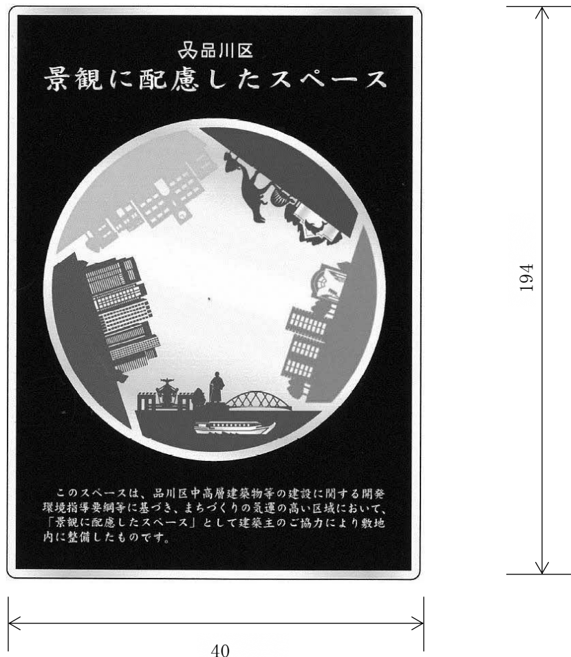
図 8 - 9 景観に配慮したエリア表示板
