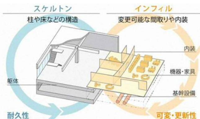
耐用年数が異なる建物の構造部分と内装や設備部分をプランニングや断面計画によって切り分け、構造部分に手を加えることなく将来の改修や設備更新に対応しやすい計画とする考え方のことです。
