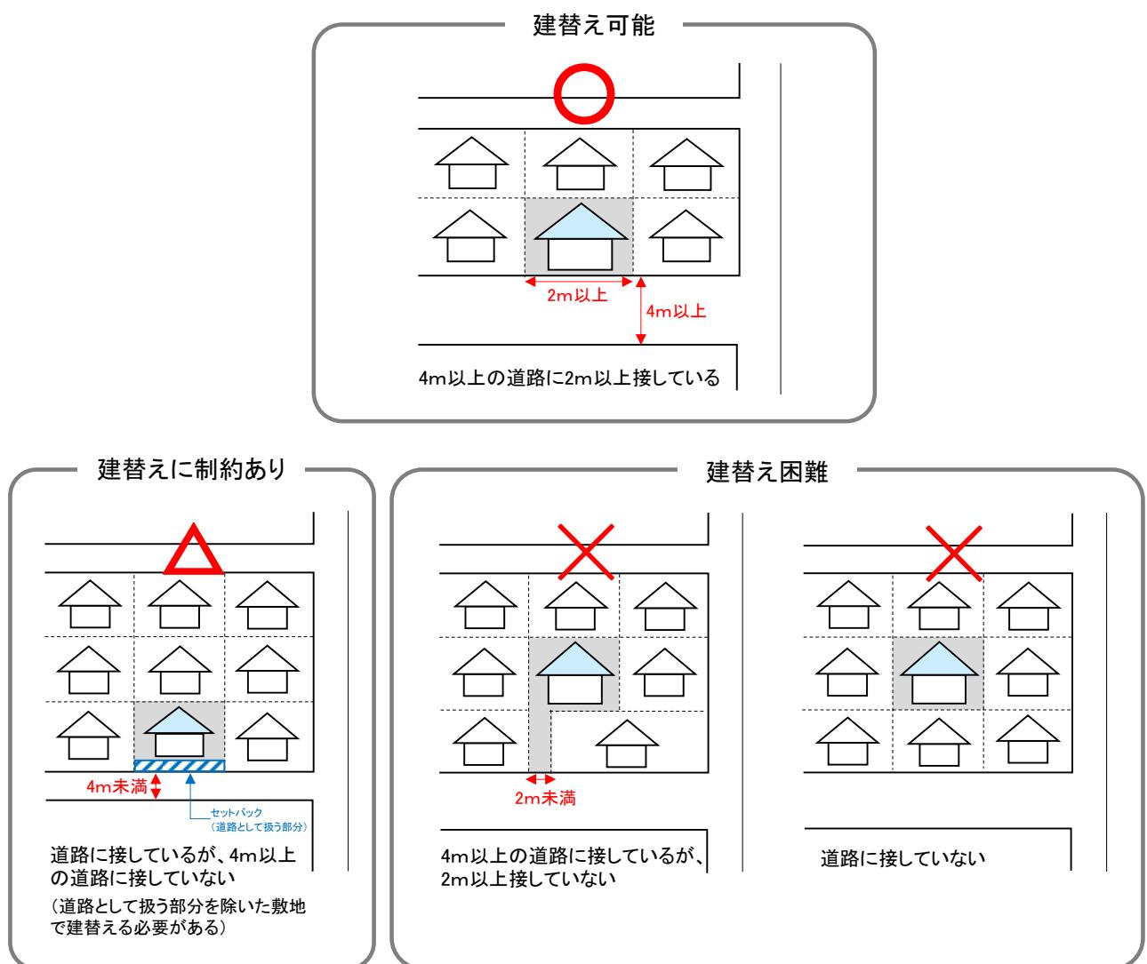
図 2-16 建築基準法における建替え制限
