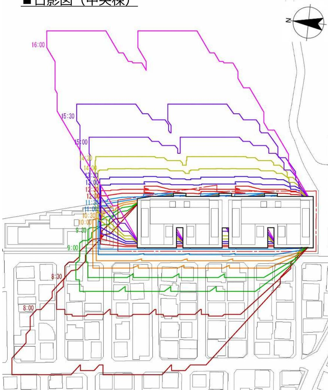
日影規制とは、建築基準法に基づいて冬至の午前8時から午後4時までの間、定められた範囲において一定時間以上の日影を生じさせないように建物の高さを制限するものです。
