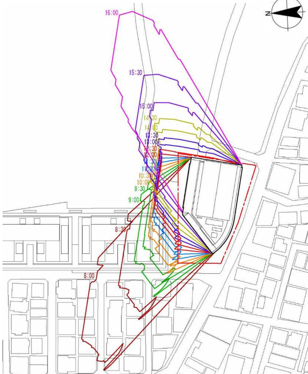
日影規制とは、建築基準法に基づいて冬至の午前8時から午後4時までの間、定められた範囲において一定時間以上の日影を生じさせないように建物の高さを制限するものです。
