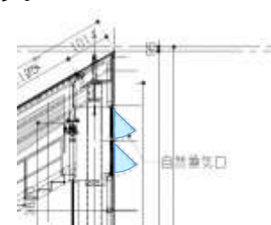
トップライト頂部の換気口
