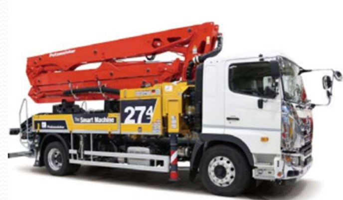
ブームポンプ車
