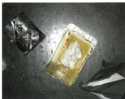
モバイルバッテリーの焼損状況
